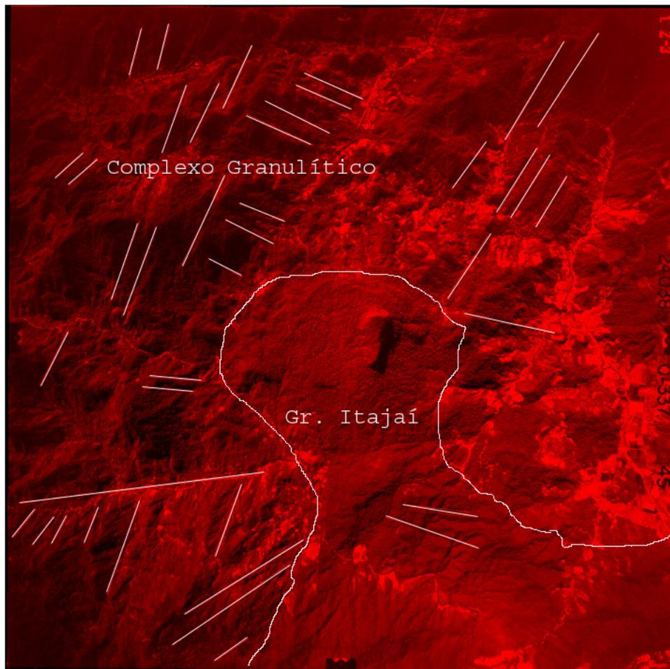
Figura 11: Fotografia aérea em infravermelho, ano de 1978, da área de estudo destacando os vales retilíneos e profundos, encaixados em falhas/fraturas (algumas destacadas com retas brancas), com direções predominantes N40°-45°E, N80°E e N60°W que ocorrem, preferencialmente entalhando áreas do Complexo Granulítico.
