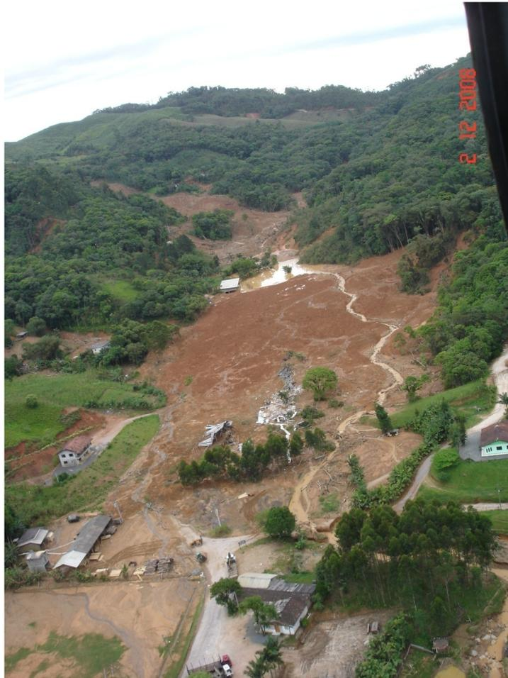
Figura 13: Localidade de Alto Baú, atingida por fluxo de lama e detritos que escoou, mesmo sob baixa declividade, pelo vale principal, alimentado por escorregamentos translacionais rasos laterais em suas encostas. Ao fundo, observa-se lago/barragem formado pelo barramento da drenagem por deslizamento lateral. Posição do vale: seta 1 da Fig. 10.
